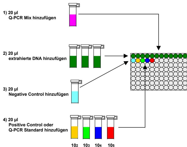
**Hinweis:** Wenn die Amplifikation mit dem Gerät **QIAsymphony® SP/AS** vorbereitet wird, die Mikrotiterplatte, welche die Extrakte, die Reagenzien und die Amplifikations-Mikrotiterplatte enthält, mithilfe der Spezialadapter in die dafür vorgesehenen Fächer einsetzen, anschließend die Angaben in der Gebrauchsanweisung des Einrichtungmoduls und die von der Software geforderten Schritte befolgen.
