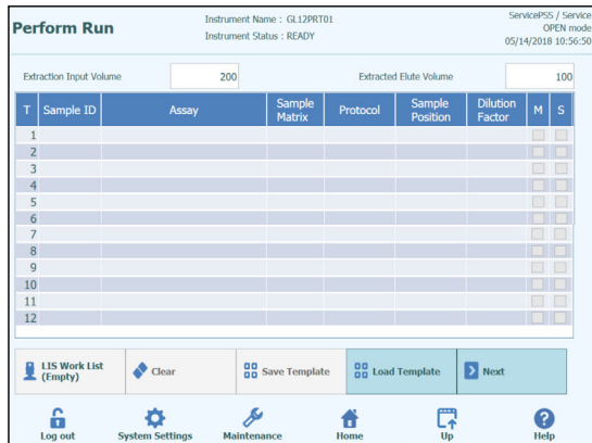
Figure 3 : Page « Perform Run » (Exécuter un cycle)
