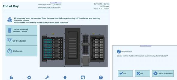
Selezionare 'Yes' (sì) per arrestare il sistema una volta completata la sterilizzazione UV.
