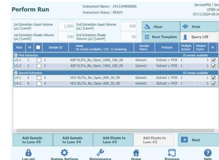
19 Se non vi sono altre provette eluato o si è selezionato 'PCR Only/Calibration/Control', cliccare su 'Next' (avanti) per visualizzare la schermata 'L2 Reagent/Elution Rack Insertion' (inserimento del rack per provette reagente/eluato L2).
