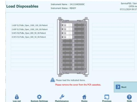
31 Posizionare la cassetta per reazione PCR nell'apposito rack come mostrato nella figura descrittiva dell'installazione e applicare il rack per PCR sulla base dello strumento.
