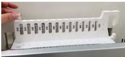
Figura 5-132: Inserção de um tubo de eluição vazio no suporte
