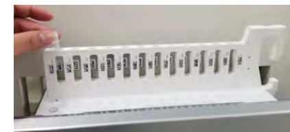
Figura 5-139: Inserção do tubo de reagente no suporte
