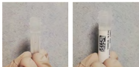
Figura 5-89: Cole a etiqueta impressa no tubo de eluição
