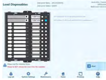
Figura 5-189: Os tubos de extração apresentam uma cor diferente: cinzento para vazio, azul claro para contendo amostra.
