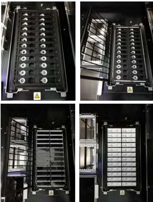
Figura 5-181: Instalação de cassetes de PCR no suporte de PCR do instrumento
