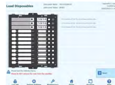
Figura 5-182: Instalação das cassetes de extração, conjuntos de pontas e tubos de extração necessários para a execução
