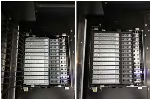
Figura 5-183: Instalação de cassetes de extração, conjuntos de pontas e tubos de extração vazios no suporte de extração do instrumento
