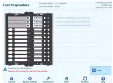
Figura 5-188: Instalação das cassetes de extração, conjuntos de pontas e tubos de extração necessários para a segunda extração
