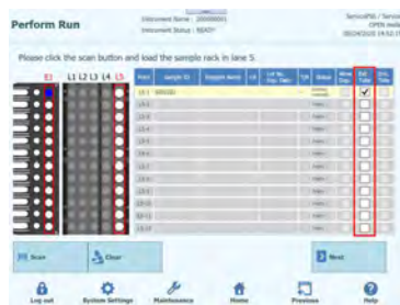
Figura 5-46: Verificação do tubo de extração
