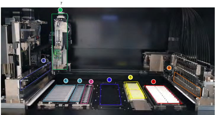
Figura 1-2: Instrumento ELITe BeGenius – Vista da área de trabalho
