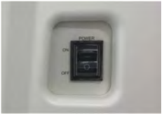
Figura 5-226: O interruptor de alimentação está no lado direito do instrumento
