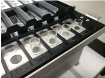
Figura 5-166: Inserção de tubos de extração no suporte de extração
