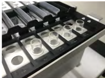
Figura 5-166: Inserimento dei tubi di estrazione nel basket di estrazione
