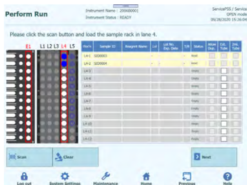
Figura 5-76: Scansione dei tubi avvenuta correttamente
