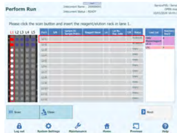
Figura 5-145: Selezione della posizione della cooling unit in cui è stato inserito il reagente
