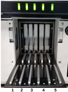
Figura 1-3: Lo strumento ELITE BeGenius – Area di caricamento
