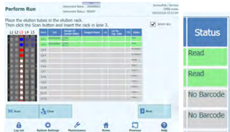
Figura 5-125: Mancata lettura del codice a barre del tubo del Controllo
