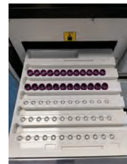
Figura 1-4: Strumento ELITE BeGenius: vassoio di lavoro
