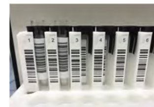
Figura 5-74: Inserimento corretto dei tubi con barcode nel rack
