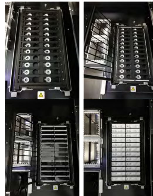
Figura 5-181: Installazione delle cassette di PCR nel rack di PCR
