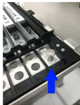
Figura 5-48: Inserimento del tubo di estrazione nel basket di estrazione
