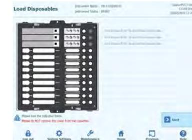
Figura 5-182. Colocación de los cartuchos de extracción, de los juegos de puntas y de las probetas de extracción que se necesitan para la serie
