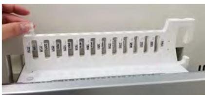
Figura 5-132. Inserción de la probeta de eluido en la gradilla
