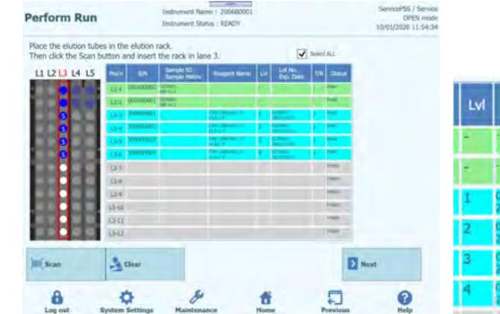
Figura 5-111. Selección de los niveles para la probeta de calibración
