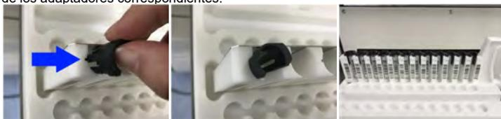
Figura 4-5. Inserción de los adaptadores de gradillas de muestras en la gradilla del ELITE BeGenius
