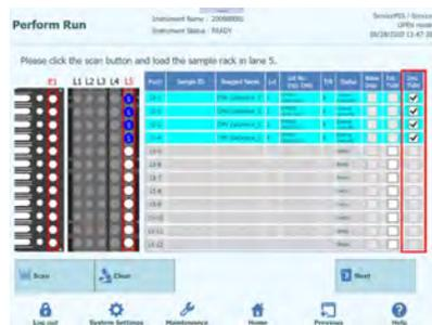
Figura 5-160. Activación de la opción correspondiente a la probeta de 2 mL para una probeta del calibrador de 2 mL
