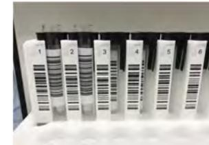
Figura 5-74. Inserción correcta en la gradilla de las probetas de muestras con códigos de barras
