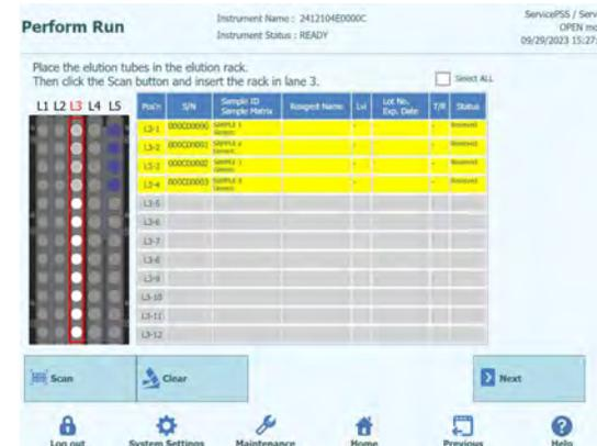
Figura 5-99. Estado «Reserved» (Reservada) para el «Elution Tube» (Tubo de elución) sin código de barras
