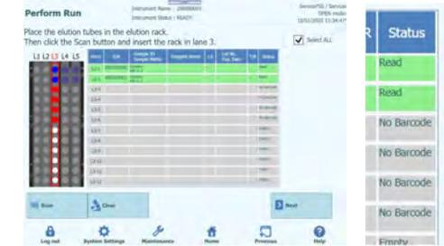
Figura 5-114. Estado «No Barcode» (No hay código de barras) cuando no se ha pegado ninguna etiqueta a la probeta de calibración,
