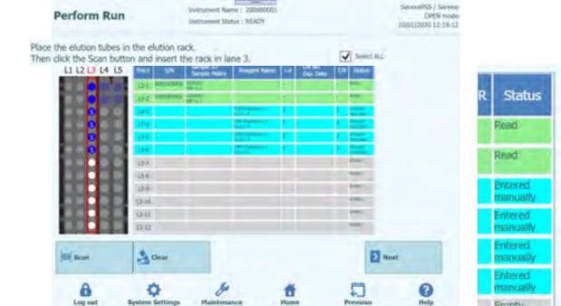
Figura 5-115. Selección del reactivo de calibrador en la columna «Reagent Name» (Nombre del reactivo).
