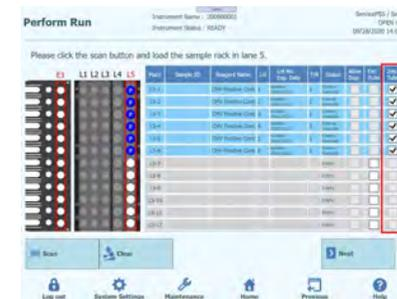
Figura 5-161. Activación de la opción correspondiente a la probeta de 2 mL para una probeta del control de 2 mL
