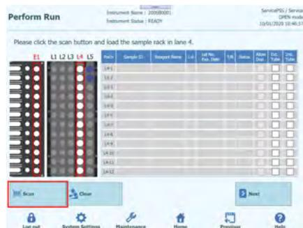
Figura 5-75. Activación del escaneado de los códigos de barras de la gradilla de muestras del carril L4
