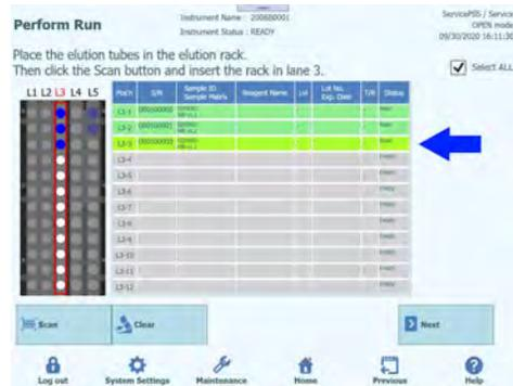
Figura 5-104. Estado «Read» (Leído) si el código de barras de la probeta de eluido se ha leído correctamente
