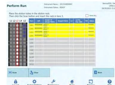
Figura 5-102. Activación del escaneo de los códigos de barras de la gradilla de elución del carril L3
