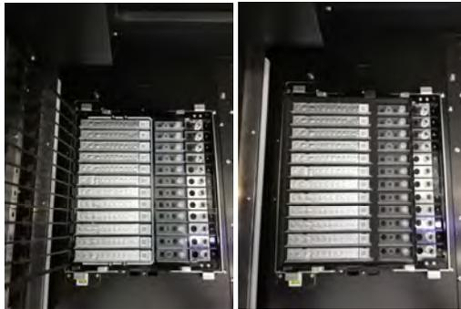
Figura 5-183. Colocación de los cartuchos de extracción, de los juegos de puntas y de las probetas de extracción vacías en la gradilla de extracción del instrumento
