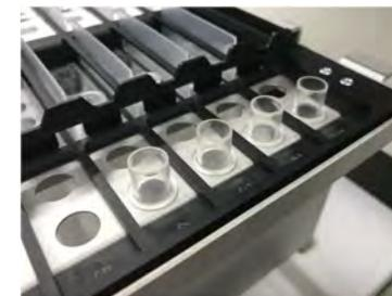
Figura 5-166. Inserción de las probetas de extracción en la gradilla de extracción
