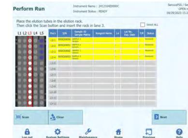
Figura 5-120. Activación del escaneado de los códigos de barras de la gradilla de elución del carril L3
