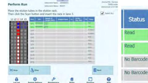
Figura 5-125. Estado «No Barcode» (No hay código de barras) cuando no se ha pegado ninguna etiqueta a la probeta del control,
