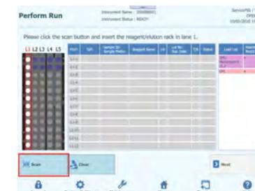
Figura 5-140. Activación del escaneo de los códigos de barras de la gradilla de reactivos del carril L1
