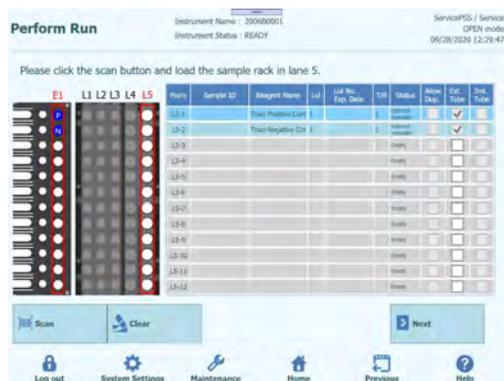
Figura 5-165. Activación de la opción correspondiente a una probeta de extracción que contiene reactivo del control
