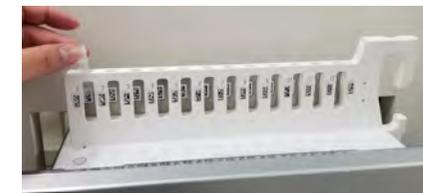
Figura 5-139. Inserción de la probeta de reactivos en la gradilla
