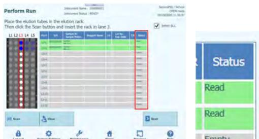
Figura 5-94. Código de barras de la probeta de elución leído correctamente
