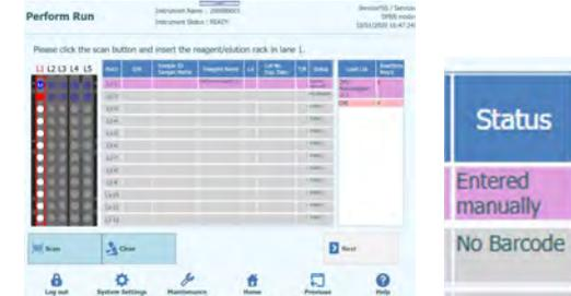
Figura 5-146. Estado «Entered manually» (Introducido manualmente) cuando la información del reactivo se ha introducido manualmente
