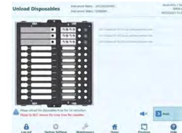
Figura 5-186. Distribución de los cartuchos de extracción, de los juegos de puntas y de las probetas de extracción utilizados en la primera extracción
