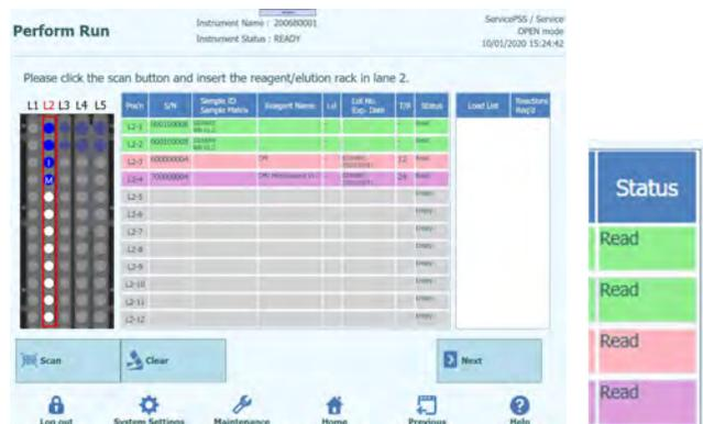
Figura 5-136. Estado «Read» (Leído) si los códigos de barras de las probetas de reactivos se han leído correctamente
