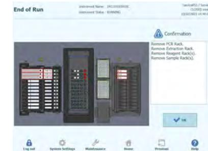
Figura 5-216. Pantalla «End of Run» (Fin de la sesión) con instrucciones sobre cómo descargar, almacenar o descartar las muestras, los materiales y los reactivos.
