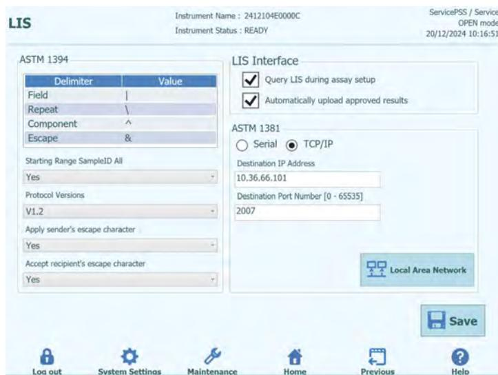
Figura 6-13. Configuración TCP/IP
