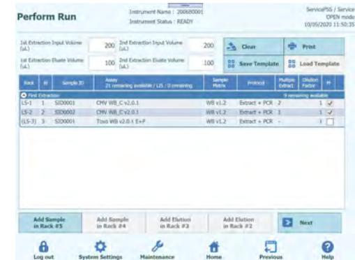
Figura 5-69. Selección de un protocolo de ensayo (Assay Protocol) distinto en el caso de una extracción múltiple («Multiple Extract»)
