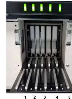
Figura 1-3. Instrumento ELITE BeGenius. Vista del área de carga
