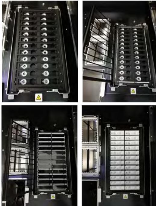
Figura 5-181. Colocación de los PCR Cassette en la gradilla de PCR del instrumento
