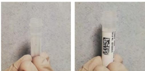
Figura 5-83. Pegar la etiqueta impresa en la probeta de elución.
