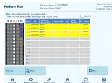
Abb. 5-102: Aktivieren des Barconde-Scans am L3-Elutionsrack
