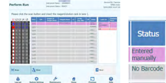
Abb. 5-146: Status „Entered manually“ (Manuell eingegeben) bei manueller Eingabe der Reagenzinformationen
