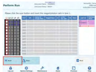
Abb. 5-140: Barconde-Scan des L1-Reagenzracks aktivieren
