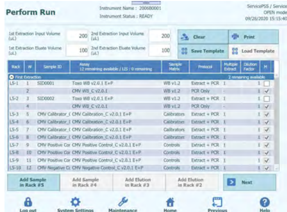
Abb. 5-173: Bildschirm der zugewiesenen Assay-Protokolle in der Spalte „W“ von Well 1 ausgehend
