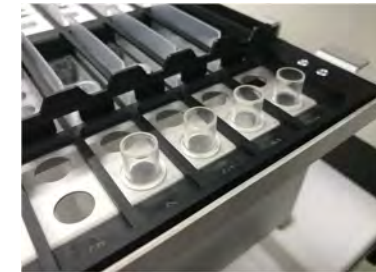
Abb. 5-166: Einsetzen von Extraktionsröhrchen in das Extraktionsrack
