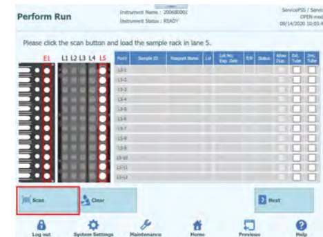
Abb. 5-35: Aktivierung des Barconde-Scans des L5-Probenracks
