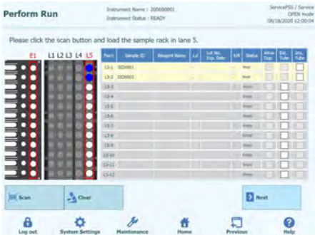
Abb. 5-36: Barcode-Scanergebnisse des Racks
