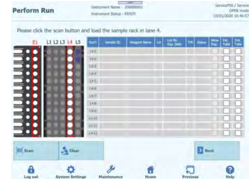
Abb. 5-72: Fenster zum Einsetzen des L4-Probenracks
