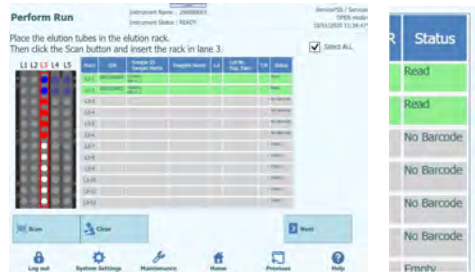
Abb. 5-114: Status „No Barcode“ (Kein Barcode), wenn kein Etikett am Kalibrierröhrchen angebracht ist
