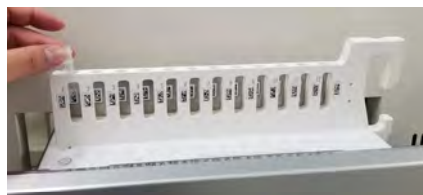
Abb. 5-132: Einsetzen eines leeres Eluatröhrchens in das Rack
