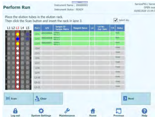
Abb. 5-70: Mehrere Eluatröhrchen für eine Proben-ID bei „Multiple Extract“ (Mehrere extrahieren)
