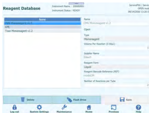
Abb. 6-41: Auswahl eines Reagenzes aus der Liste „Name“ im Bildschirm „Reagent Database“ (Reagenzdatenbank)
