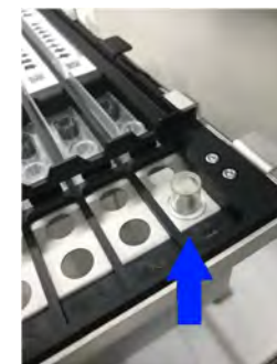
Abb. 5-48: Einsetzen von Extraktionsröhrchen in das Extraktionsrack
