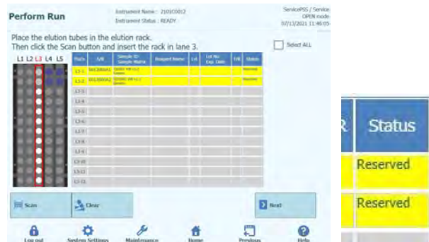
Abb. 5-92: Korrekte Position der Elutionsröhrchen im Rack
