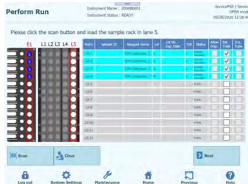
Abb. 5-164: Kontrolle des Extraktionsröhrchens, wenn Kalibratorreagenz in einem Extraktionsröhrchen ist
