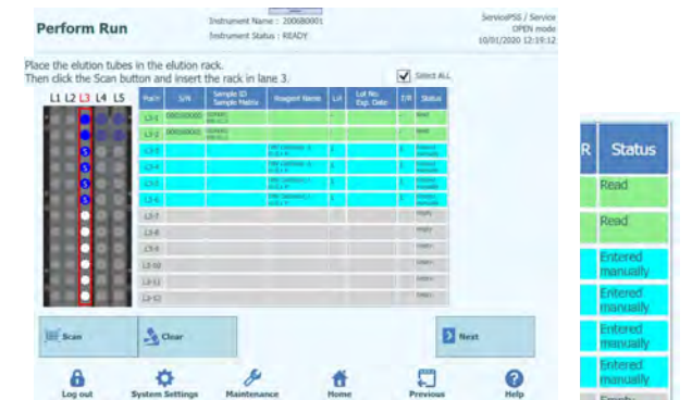
Abb. 5-115: Auswahl des Kalibratorreagenzes in der Spalte „Reagent Name“ (Reagenzname)
