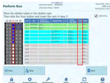
Abb. 5-118: Eingabe der Anzahl Reaktionen für das Kalibratorreagenz-Röhrchen
