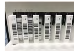
Abb. 5-74: Korrektes Einsetzen der barcodierten Probenröhrchen in das Rack
