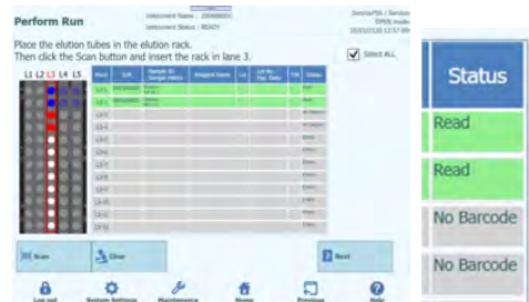
Abb. 5-125: Status „No Barcode“ (Kein Barcode), wenn kein Etikett am Kontrollröhrchen angebracht ist
