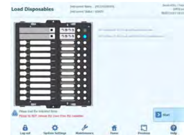
Abb. 5-189: Anzeige unterschiedlicher Farben für Extraktionsröhrchen: grau, wenn sie leer sind, hellblau, wenn sie eine Probe enthalten.
