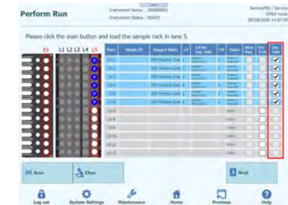
Abb. 5-161: Markieren der Spalte „2 mL Tube“ (2-ml-Röhrchen) bei einem 2-ml-Kontrollröhrchen
