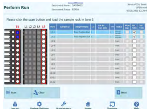
Abb. 5-165: Kontrolle des Extraktionsröhrchens, wenn Kontrollreagenz in einem Extraktionsröhrchen ist
