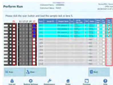
Abb. 5-160: Markieren der Spalte „2 mL Tube“ (2-ml-Röhrchen) bei einem 2-ml-Kalibratorröhrchen
