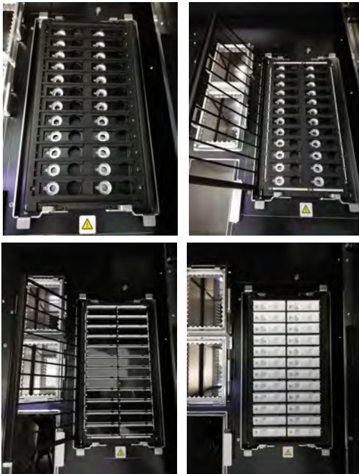
Abb. 5-181: Einsetzen von PCR-Kassetten auf das PCR-Rack des Geräts
