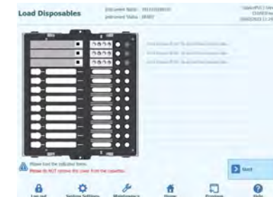
Abb. 5-182: Einsetzen der für den Lauf benötigten Extraktionskassetten, Spitzensets und Extraktionsröhrchen
